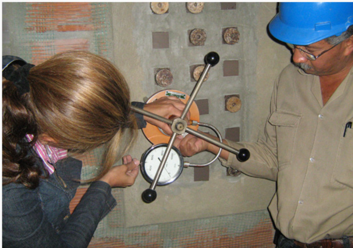
Figura 8-21: Ensayo de adherencia del sistema de revestimiento.
