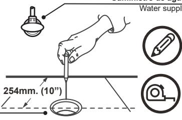
2. El centro del desagüe del piso y la brida sanitaria (**NO INCLUIDA**) deben estar a 254 mm. (10") desde la parte posterior de la pared.
