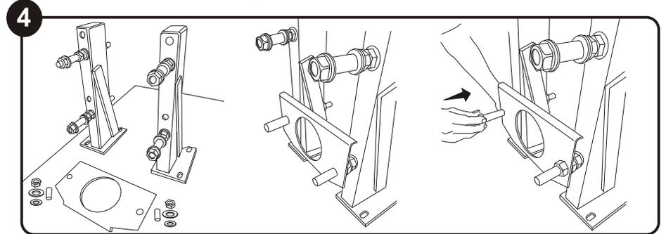
Retire la platina, las tuercas, el protector plástico, las arandelas plásticas y metálicas en los tornillos espárragos inferiores. Monte la platina y las tuercas y apriete fuertemente con una llave ajustable hasta garantizar la rigidez de la estructura.
