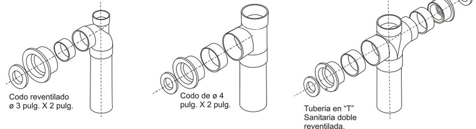
\*Los nipples vienen incluidos para tubo de descargas de 3" y 4". Instale con soldadura de PVC de acuerdo a su descarga definida.
