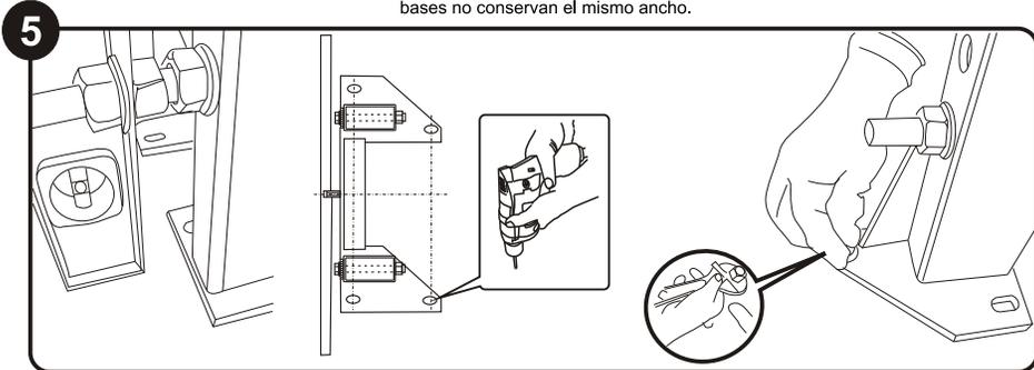
Verifique con un nivel que las columnas se encuentren niveladas (vertical y horizontalmente) y marque los puntos sobre el piso y perforo con un taladro manual. Usando una llave ajustable apriete los pernos de anclaje de 0 1/2" x 3" de longitud (No Incluidos). La forma de los agujeros le permitirán hacer ajustes hacia adelante o hacia atrás de la pared terminada. Los pernos de anclaje deben sobresalir 30mm. del piso terminado para la correcta instalación del soporte.
