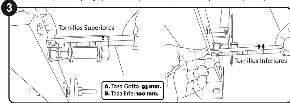
Retire las tuercas, arandelas y el protector plástico en los tornillos espárragos inferiores. Ubique la platina metálica en posición de instalación. Ajuste las medidas de instalación, dejando que los tornillos sobresalgan **100 mm.** ó **93 mm.** (según modelo de taza) desde la cara externa de la columna tanto en los tornillos espárragos superiores como en los inferiores, debido a que sus bases no conservan el mismo ancho.
