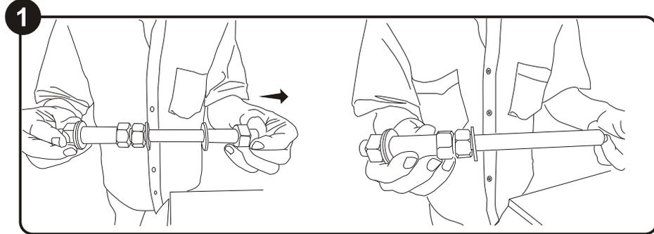
Defina previamente su modo de instalación. Si su instalación va ser Estándar, ubique los travesaños en los puntos (A). Si su instalación va ser (ADA), ubique los travesaños en los puntos (B). **Ver diagrama de instalación inicial.** Posteriormente, tome los espárragos y retire la tuerca y la arandela metálica del lado que NO tiene el protector plástico.
