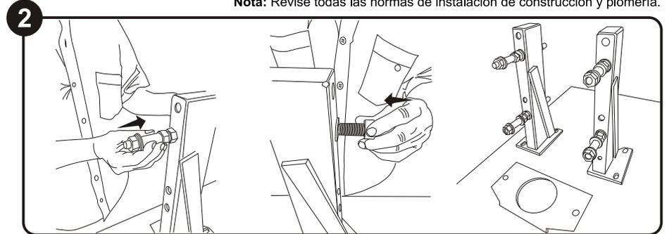
Introduzca los tornillos espárragos en las perforaciones de la columna tomando estos del protector plástico. Instale la arandela metálica y la tuerca por la parte de atrás. Repita este proceso con los tornillos espárragos faltantes en ambas columnas. Repita este procedimiento con los tornillos inferiores
