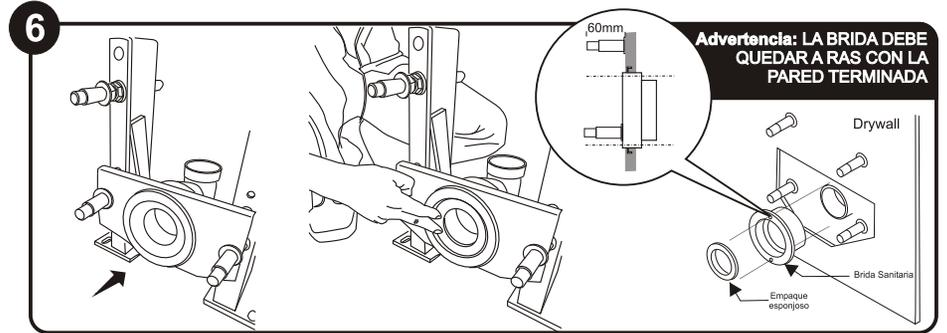
instale las tuercas, arandelas y el protector plástico en los tornillos espárragos inferiores. Verifique que los pernos de anclaje estén debidamente apretados, posteriormente ubique la brida sanitaria en posición de instalación y pegue esta al codo de descarga con soldadura PVC (En el respaldo de la hoja podrá ver el tipo de montajes del tubo de descarga). Ubique el empaque de caucho esponjoso en posición de instalación. Los tornillos deben sobresalir 60mm del drywall.
