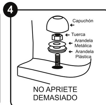
Coloque las arandelas plástica y metálica como se indica en el gráfico, coloque las tuercas y apriete. Corte el exceso del tornillo con una sierra, si es mayor a 1/4" (6mm), coloque el casquete sobre el tornillo.
