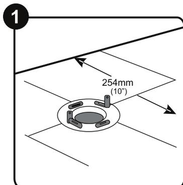
El centro de desagüe del piso y de la brida debe estar a 10" (254mm) desde la parte posterior de la pared.
