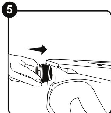
Instale el racor en la entrada posterior de la taza de modo que el empaque de caucho se inserte en la taza.
