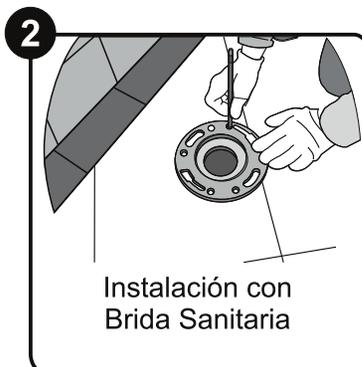
Instale la brida sanitaria según las recomendaciones de CORONA. Ponga la taza sobre una superficie suave para evitar dañar la superficie terminada de la taza. Coloque la brida sanitaria en el desagüe.
