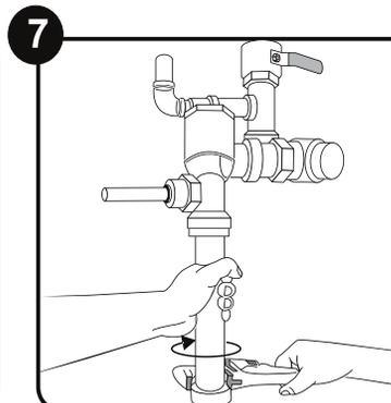
Instale la válvula de descarga según las instrucciones de instalación del fabricante, (siga las instrucciones incluidas en la válvula de descarga). Abra el suministro de agua para la válvula de descarga.
