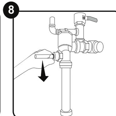
Instale el mueble del sanitario (no incluido) según las instrucciones del fabricante. Accione la descarga del sanitario varias veces y verifique que no haya fugas en las conexiones.
