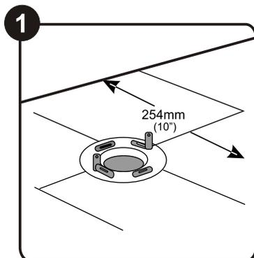
El centro de desagüe del piso y de la brida debe estar a 10" (254mm) y/o 12" (300mm) desde la parte posterior de la pared.
