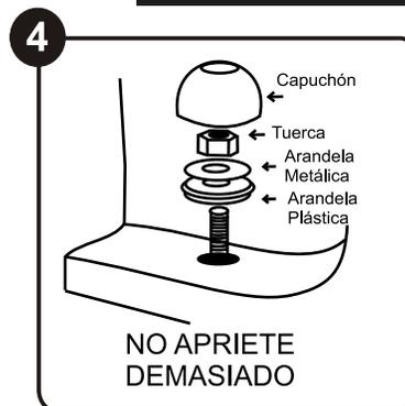
Coloque las arandelas plástica y metálica como se indica en el gráfico, coloque las tuercas y apriete. Corte el exceso del tornillo con una sierra, si es mayor a 1/4" (6mm), coloque el casquete sobre el tornillo. **NO APRIETE DEMASIADO**
